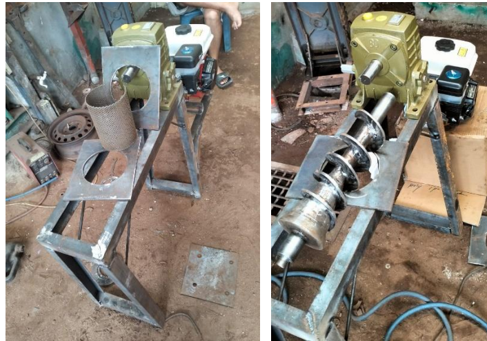
Gambar 4. Proses Perakitan Mesin Screw Press
