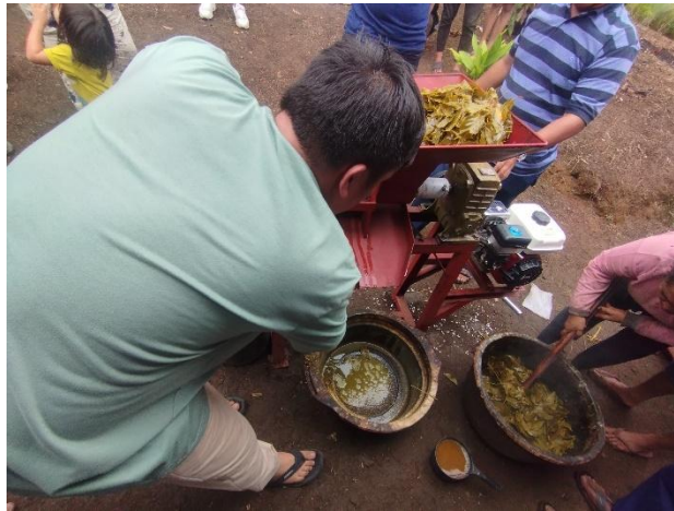
Gambar 12. Proses pengumpulan getah gambir
