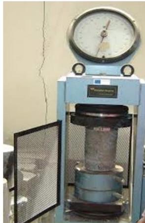
**Gambar 2.** Pengujian kuat tekan pada benda uji
