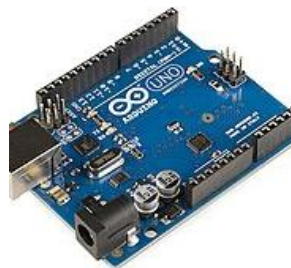
Gambar 2. Arduino Uno (Sumber: id.wikipedia.org)
