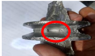
Gambar 3.4. Cacat rongga udara.
