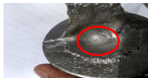
Gambar 3.5. Cacat penyusutan luar, terlihat seperti rongga
