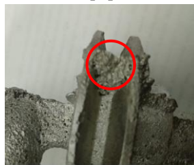
Gambar 3.8 Cacat yang terjadi akibat cetakan yang rontok.
