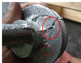
Gambar 3.9 Cacat yang disebabkan pasir cetak yang melekat pada permukaan produk hasil coran
